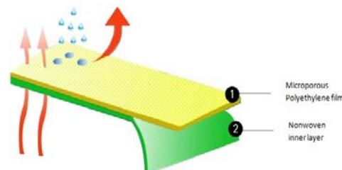
El uso de dos finas capas microporosas de alta calidad, proporcionan una efectiva barrera contra líquidos y partículas, permitiendo la transmisión del vapor de agua de dentro hacia fuera
